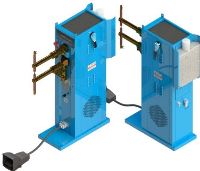
PUNTATRICE A COLONNA serie SPF-C con comando elettropneumatico e refrigeratore incorporato
